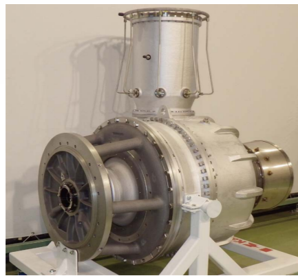
原動機 (ガスタービン) 外観
