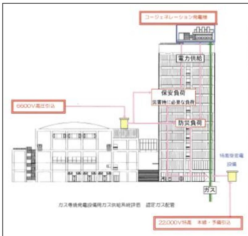
図-3 電気設備概要<sup>(\*4)</sup>
