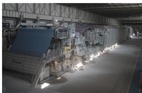
図-4 N-1マシン（塗工紙生産設備）外観
