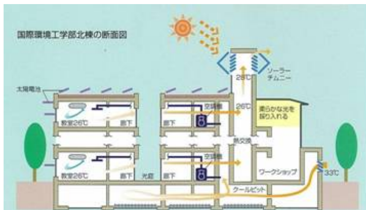
図-3 換気用の煙突 (ソーラーチューブ) の仕組み (*2)
